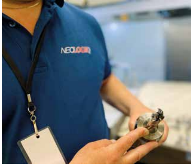
Borrkärets stora anliggningsyta mot borkroppen fördelar kraften vid borring och infästningen är konstruerad så att den ger ökad livslängd.
