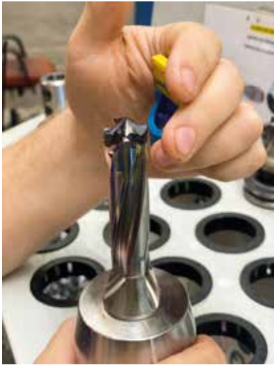
Tillförlitlig koppling mellan borrar - borkropp och borring utan ställtid
