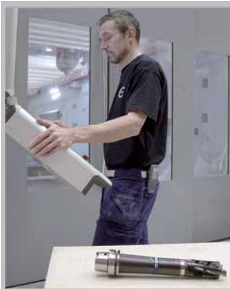
I Volvo Cars verkstad NC-Milling arbetar några av företagets vassaste NC-tekniker. Här med nya höghastighetsfräsen från Breton som klarar helkarossfräsning i skala 1:1. Fotograf: Ulf Samuelsson, tidningen Maskinoperatören
